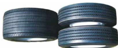
Rys. 2. Opona typu „Super Single” i dwie opony bliźniacze (materiały firmy Michelin).
