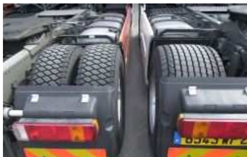
Rys. 3. Opony na oś napędową – opona tradycyjna „bliźniacza” i opona typu „super single drive” (materiały firmy GoodYear).
